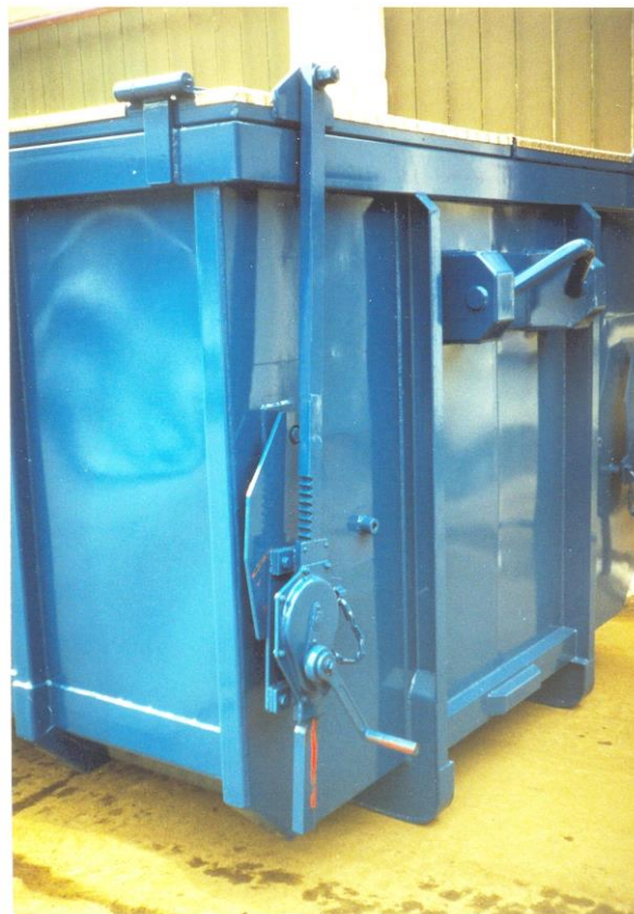
a konténer emelőszerkezeti részei – a felvevő kampó és a tetőajtó nyitószervezet a fogasléces emelővel (saroknézetből)
